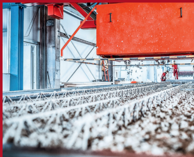
4. Automatisches Betonieren der jeweiligen Elementwandschale
