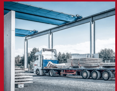
6. Verladung der fertig betonierten und ausgetrockneten Elementwand
