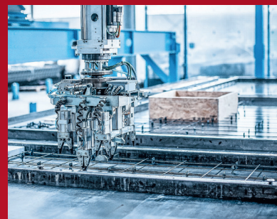
3. Einlegen der Bewehrung auf dem Schalungstisch
