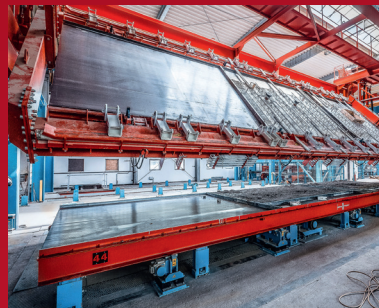
5. Verbinden von Innen- und Außenschale der Elementwand
