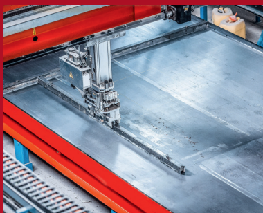
2. Einlegen der Schalung auf dem Schalungstisch
